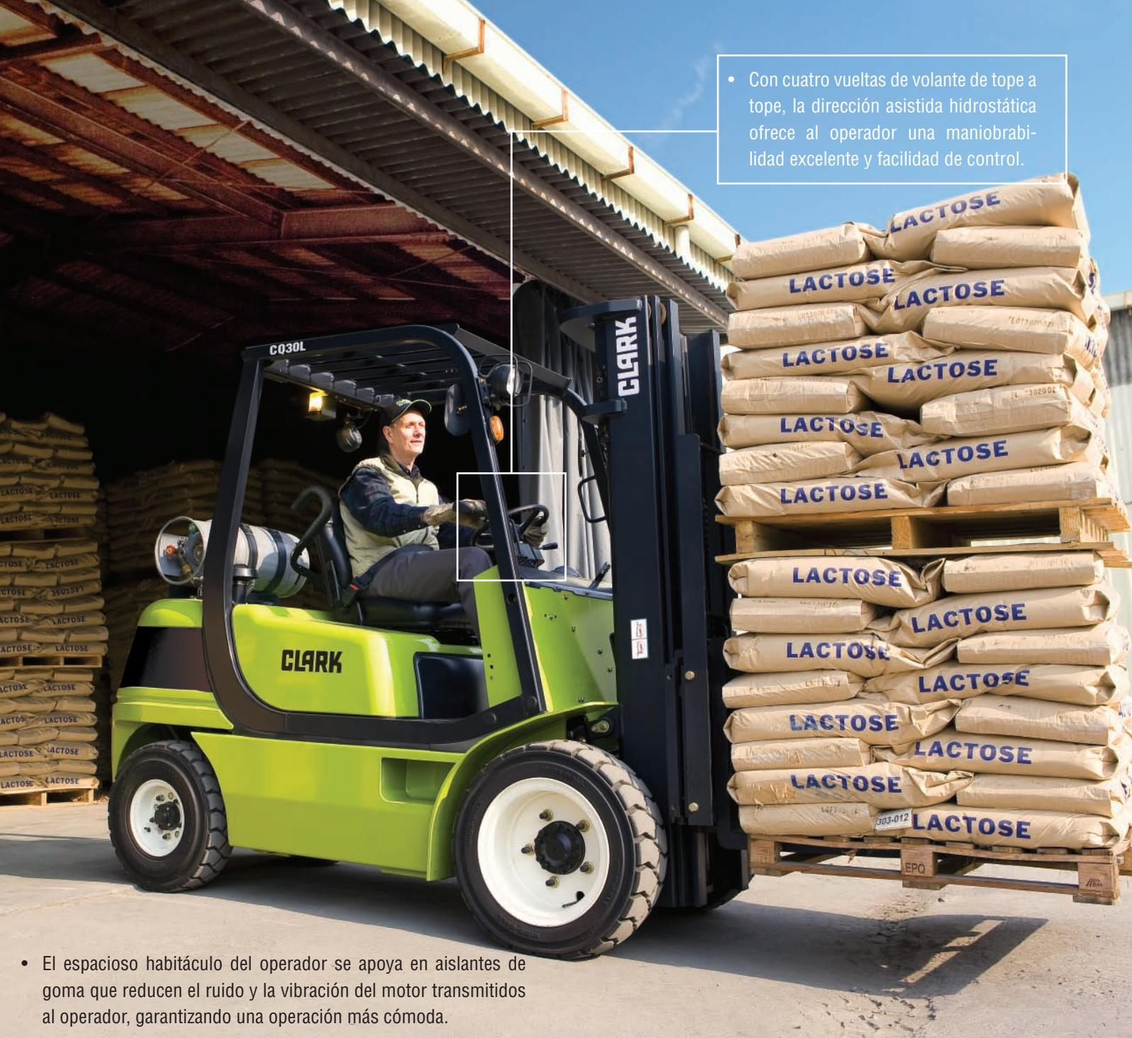
• El espacioso habitáculo del operador se apoya en aislantes de goma que reducen el ruido y la vibración del motor transmitidos al operador, garantizando una operación más cómoda.
